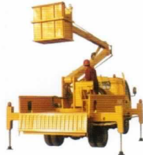
高空作业车 Aerial Platform Truck
