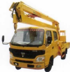
高空作业车 Aerial Platform Truck
