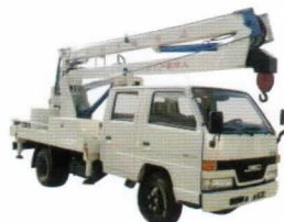
高空作业车 Aerial Platform Truck
