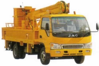
高空作业车 Aerial Platform Truck
