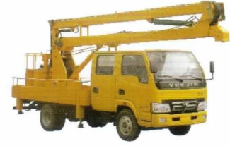
高空作业车 Aerial Platform Truck
