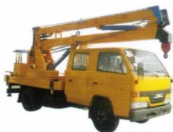
高空作业车 Aerial Platform Truck
