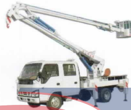
高空作业车 Aerial Platform Truck
